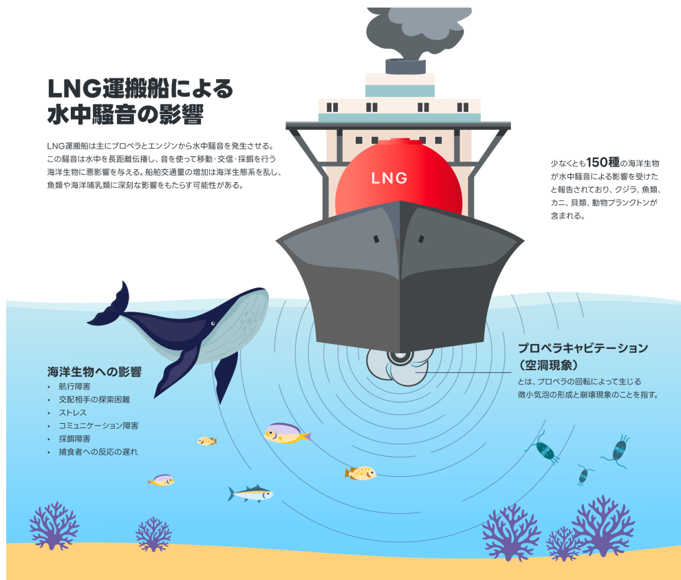
【図 4】船舶由来水中騒音の主要発生源および影響 (Clean Arctic Alliance、2023年データ)
