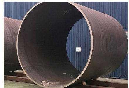
[그림8] 현대제철의 합탕 강재 실증 테스트 이력(좌)과 현대제철과 세아제강이 합작 제작한 해상풍력 하부 구조물용 강관(우)
